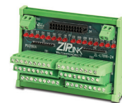
ZL-LTB16-24-1 sensor input module
