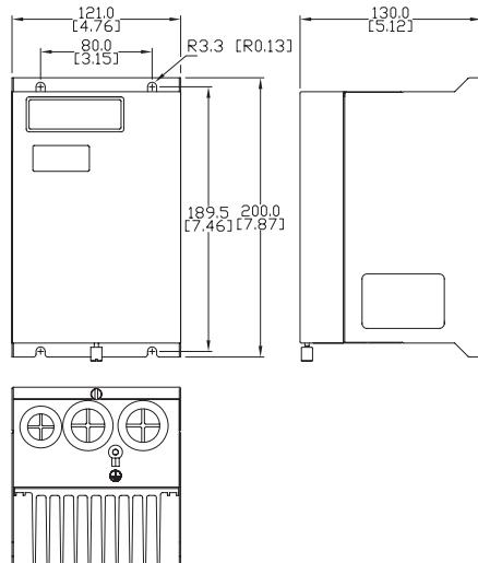
**B) DBU > 100hp (GS-5DBU, GS-6DBU, GS-7DBU)**
