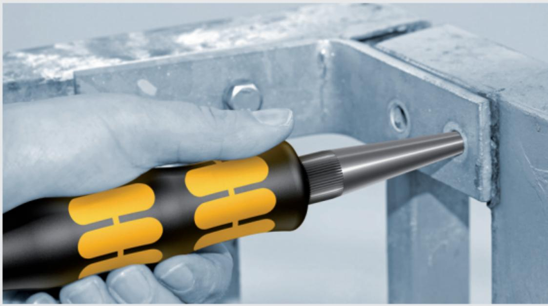
Zum Zentrieren von O-Schrauben, Ösen u. ä. kann der „Koloss“-Zentrierdorn in das Knarrenheft gesteckt und gesichert werden. (Verfahren wie bei Verlängerung)
