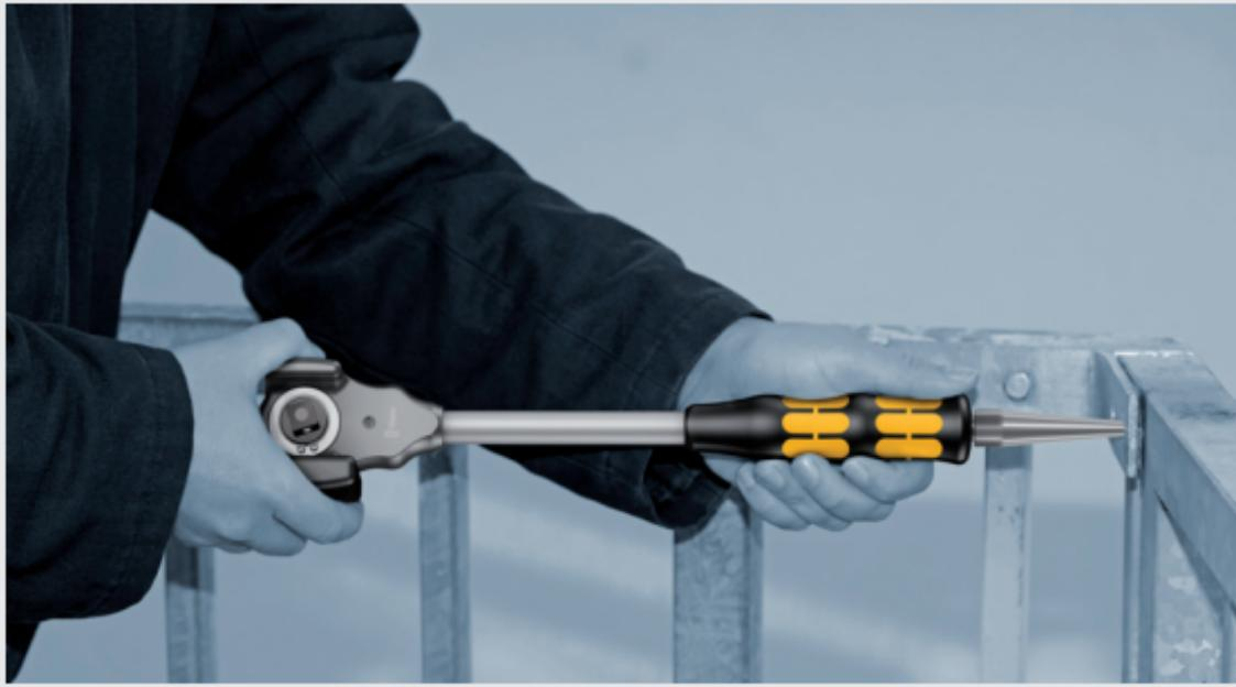
Der „Koloss“-Dorn erleichtert das Zentrieren z. B. von Ösen oder das Ausrichten von Bohrungen.
