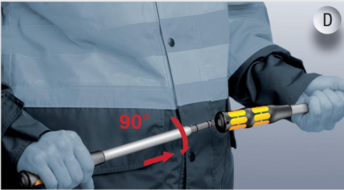
Die flache Seite des Verlängerungsheftes muss im 90°-Winkel zur flachen Seite des Knarrenheftes stehen. Setzen Sie die Verlängerung in die Bohrung des Knarrenheftes ein.
