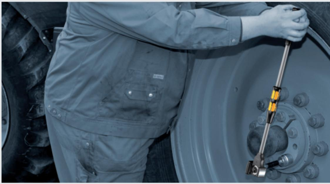
Die „Koloss“-Verlängerung ermöglicht die Übertragung höherer Drehmomente, ohne Gefährdungen, wie sie durch das unsachgemäße Aufstecken von Rohren u. ä. entstehen können.
