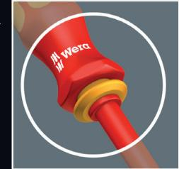
deben comprobar la correcta conexión entre el mango y la varilla y la integridad del aislamiento. Si existe alguna duda hay que reemplazar los componentes.
