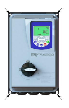
(b) Location of the screws to close the unit (b) Ubicación de los tornillos para cierre
