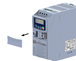
(a) Removal of the communication accessory cover (a) Remoción de la tapa de accesorios de comunicación (a) Remoção da tampa de acessórios de comunicação
