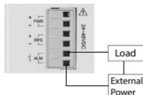
Der 852-1812/010-000 verfügt über eine Alarmkontakt-Anschlussstelle. Dieser Relaiskontakt verwendet zwei Kontakte der Stiftleiste auf der Oberseite des 852-1812/010-000.
