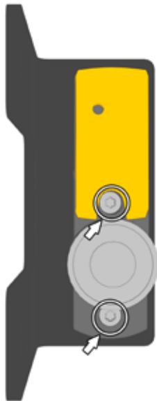
Abb.7: Prozesszuhalterung auf Montageplatte anbringen und Schrauben M6 x 25 mm Torx festziehen.
