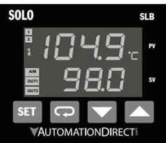
PV Display: Display the process value or parameter type.
