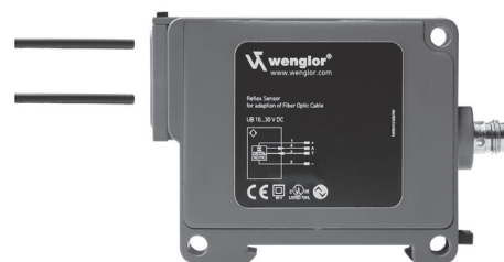
Abb. 7: Anschließen von Kunststofflichtleitern
