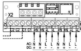
Подключение рабочего напряжения излучателя звука Подключение рабочего напряжения лампы-вспышки
