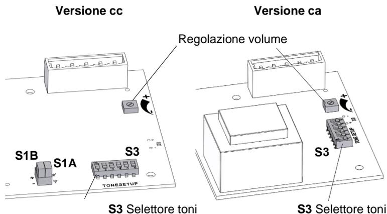
**S1B:** selezione della polarità della tensione di comando per C1 e C2 (controllo esterno)
