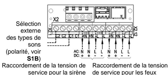
**Réglages sonores et sélection du son** (platine dans la partie supérieure de la sirène)
