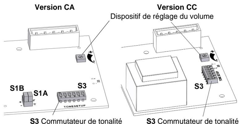
**S1B** : Sélection de la polarité de la tension de commande pour C1 et C2 (commande externe)
