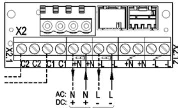
Подключение рабочего напряжения
