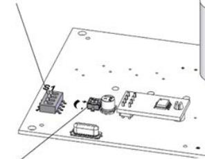
Регулирование интенсивности освещения
