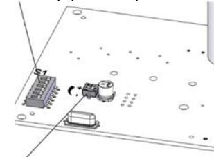
Регулирование интенсивности освещения
