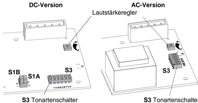
**S1B:** Auswahl der Polarität der Steuerspannung für C1 und C2 (externe Ansteuerung)
