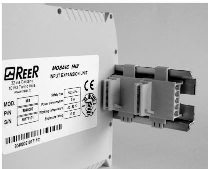
3. Fissare quindi i moduli alla barra facendo attenzione a inserire la contattiera sul fondo del modulo sul rispettivo connettore.
