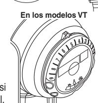
4. Para apagar la pistola de calor mueva el interruptor a la posición "I". Déjela funcionar en frío por aproximadamente tres minutos. Esto le permitirá a la pistola de calor enfriarse y a la boquilla estar fría al tacto.
