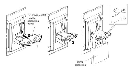
このハンドルロック装置は、ブレーカ本体のONまたはOFFの状態を南京錠でロックすることができます。 This device can be locked by Padlock in the state of ON or OFF of the breaker.
