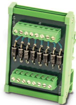
ZL-TSD8-24 Transorb Module
