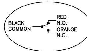
ALARM CONTACT WIRING
