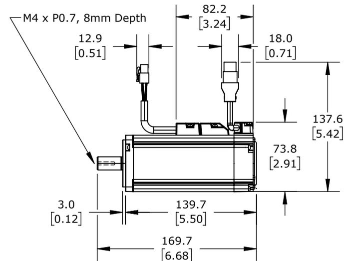
SureServo2 LOW INERTIA AC BRUSHLESS SERVO MOTOR, 400W, 3-PHASE INPUT, 24-BIT(16777216 PPR) ENCODER, INTEGRATED BRAKE, FOR USE WITH SureServo2 SV2A-4040 400W DRIVE
