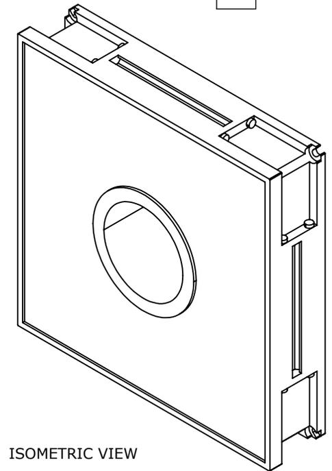
WENGLORTPL HPF-DOME MACHINE VISION LIGHTING, FLAT DOME LIGHT, WHITE LIGHT EMISSION, 5700K, 200 X 200MM LUMINOUS FIELD, 220 X 220 X 45MM HOUSING, 24 VDC OPERATING VOLTAGE.
