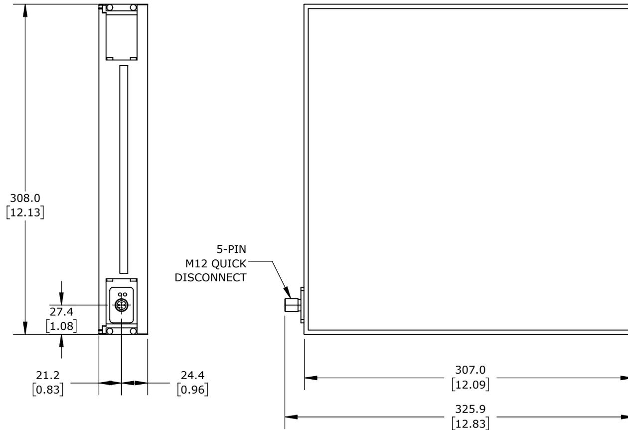
WENGLORTPL HP-BACK MACHINE VISION LIGHTING, BACKLIGHT, INFRARED LIGHT EMISSION, 300 X 300MM LUMINOUS FIELD, 320 X 320 X 45MM HOUSING, 24 VDC OPERATING VOLTAGE.
