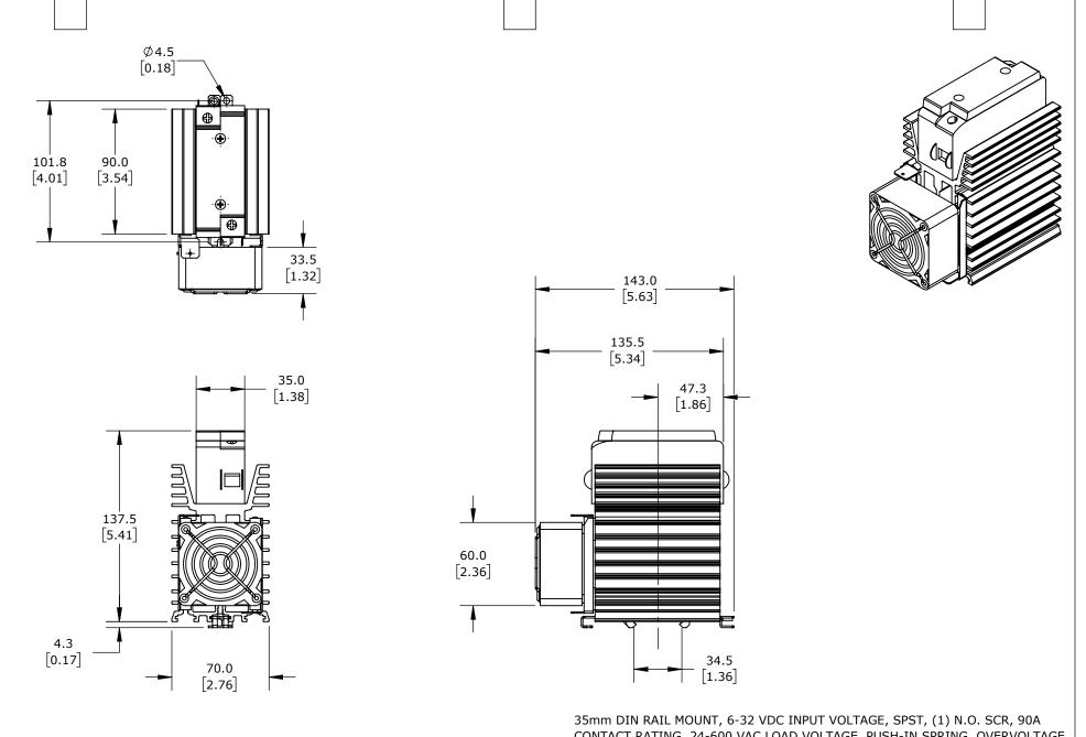
CONTACT RATING, 24-600 VAC LOAD VOLTAGE, PUSH-IN SPRING, OVERVOLTAGE
