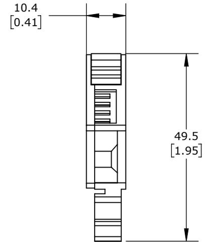
**SCREW CIRCUIT PROTECTION TERMINAL BLOCK**
