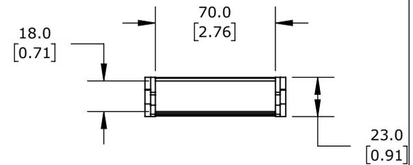
0.71IN INSIDE HEIGHT, 2.76IN INSIDE WIDTH, 3.07IN BEND RADIUS,
