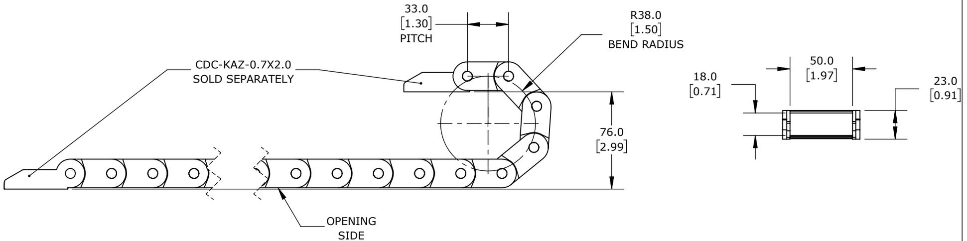
0.71IN INSIDE HEIGHT, 1.97IN INSIDE WIDTH, 1.5IN BEND RADIUS,
