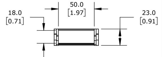
0.71IN INSIDE HEIGHT, 1.97IN INSIDE WIDTH, 1.1IN BEND RADIUS,
