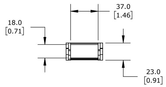
0.71IN INSIDE HEIGHT, 1.46IN INSIDE WIDTH, 1.5IN BEND RADIUS,
