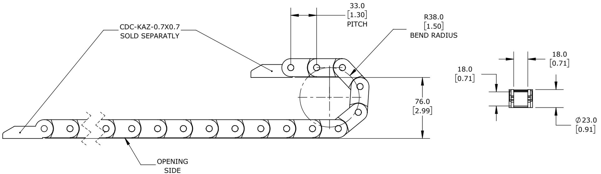
0.71IN INSIDE HEIGHT, 0.71IN INSIDE WIDTH, 1.5IN BEND RADIUS,
