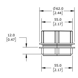
POLYAMIDE FRAME, TPE GROMMET BLOCK, M50 X 1.5MM FRAME, BLACK, (1) LARGE OPENING(S), UL TYPE 12, IP65. PACKAGE OF 5. REQUIRES (1) MURRPLASTIK KDT/X SERIES LARGE GROMMETS.
