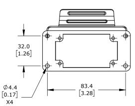
SINGLE LEVER, CONNECTOR HOUSING SIZE 10B, HEAVY-DUTY DIE CAST ALUMINUM. FOR USE WITH METE SIZE 10B 2-PEG CONNECTOR HOUSINGS.
