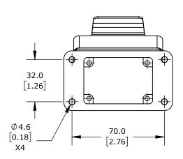
SINGLE LEVER, CONNECTOR HOUSING SIZE 6B, HEAVY-DUTY DIE CAST ALUMINUM. FOR USE WITH METE SIZE 6B 2-PEG CONNECTOR HOUSINGS.
