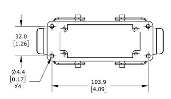
DOUBLE LEVER, CONNECTOR HOUSING SIZE 16B, HEAVY-DUTY DIE CAST ALUMINUM. FOR USE WITH METE SIZE 16B 4-PEG CONNECTOR HOUSINGS.
