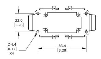
DOUBLE LEVER, CONNECTOR HOUSING SIZE 10B, HEAVY-DUTY DIE CAST ALUMINUM. FOR USE WITH METE SIZE 10B 4-PEG CONNECTOR HOUSINGS.
