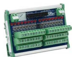
ZL-LTB16-24-1 sensor input module
