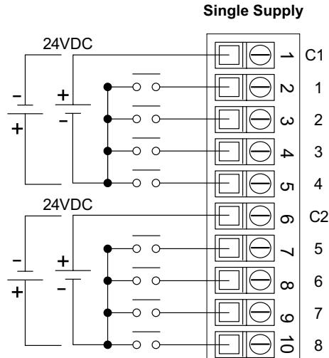
**Equivalent Input Circuit**
