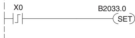
El estado normal de los bits de control para la Ramp/Soak son todos ceros. La lógica ladder debe poner sólo un bit de control a la vez.
